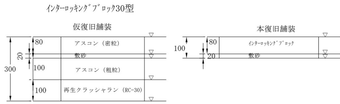
給水装置工事掘削復旧予定図 (設計図)
